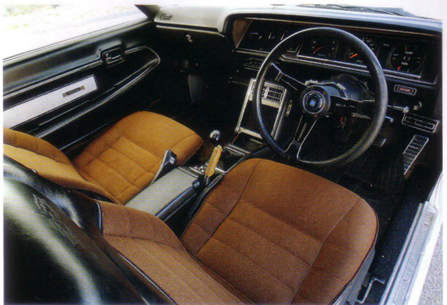
インパネは純正。スピードメーターも完動。タコメーターはドナー車からフェイスごと移植しており、正確に回転数を刻む。パワステとエアコンも動作する。
