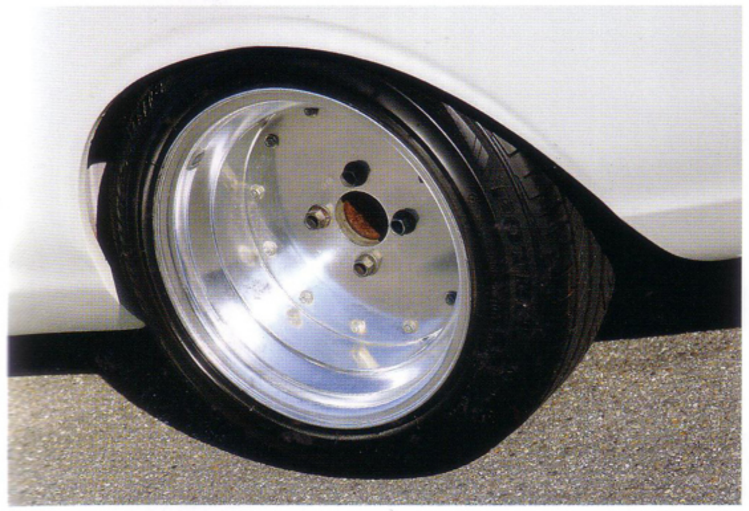
ホイールはスピードスターのマークI。組み合わせられるポテンザGIIIは、205/55R15。もちろん、引っ張りタイヤでハの字を切る!
