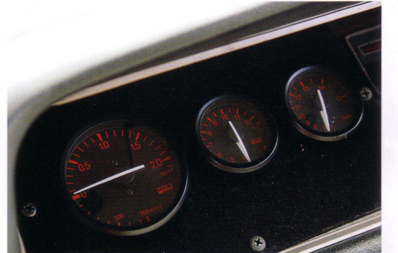
ターボ化にともない、ブースト計、温度計、排気温度計を追加。エンジン自体はノーマルだから大人しく乗ることも可能だが、本能を抑えきれないであろう。
