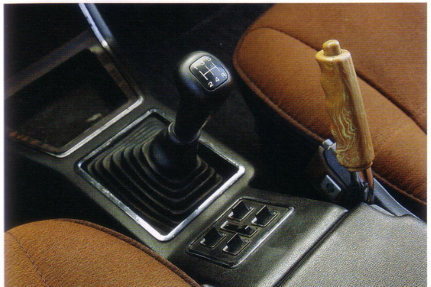
トランスミッションもRB20DETのパワーを受け止めるべく、換装されているが、センターコンソールは純正を生かしており、雰囲気を壊さない。
